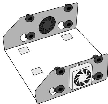
5. Befestigen Sie die HDD in der HDD-HALTERUNG mit den mitgelieferten SPEZIALSCHRAUBEN (BWH, 6-32UNC, L10.5) an den 4 Punkten. (Die Schrauben müssen ausreichend festgezogen werden, damit sie sich durch Vibrationen nicht lösen.)
