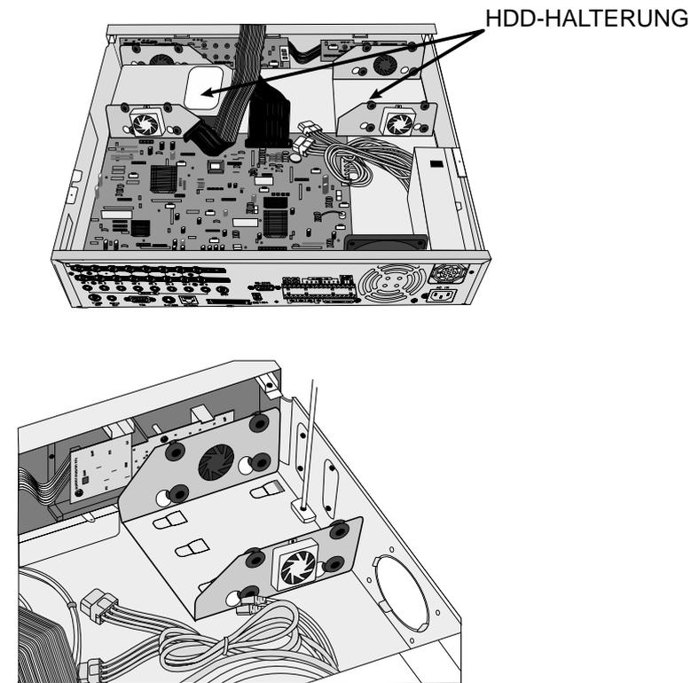
4. Ziehen Sie die HDD-HALTERUNG zur Gerätemitte und lösen Sie die Befestigung auf der Unterseite, um die HDD-HALTERUNG herauszunehmen.
