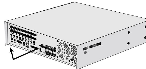
3. Das Gerät verfügt auf jeder Seite über eine Halterung zur Befestigung der Festplatten (HDD). Lösen Sie die Schrauben derjenigen Halterung, in die Sie die zusätzliche Festplatte installieren wollen.
