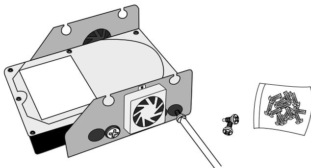
6. Setzen Sie die HDD-HALTERUNG mit der eingebauten HDD wieder an die Stelle zurück, an der Sie sie zuvor entnommen haben.
