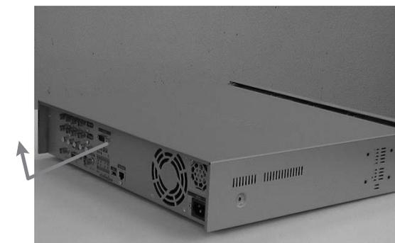
3. Links und rechts befinden sich Halterungen (Festplattenhalterungen), die zur Montage der Festplatte dienen. Sie müssen zuerst die Befestigungsschrauben der Halterung lösen, an der Sie die Festplatte montieren möchten.
