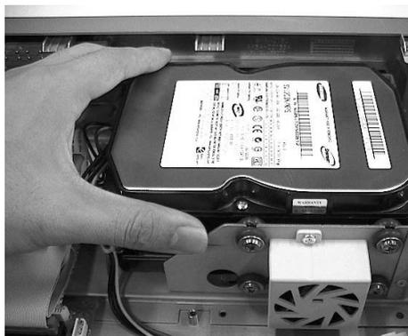
7. Stellen Sie sicher, dass die Halterung fest sitzt. Verbinden Sie dann das Stromkabel, das Kabel zur Datenübertragung (IDE-Kabel) und das Lüfterkabel mit der Festplatte.
