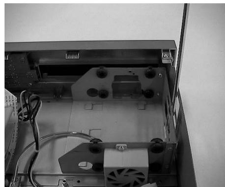
4. Zum Entfernen der Festplattenhalterung lösen Sie das Stromkabel, das Kabel zur Signalübertragung (IDE-Kabel) und das Lüfterkabel. Ziehen Sie die Halterung dann zur Mitte des Geräts, um sie vom Gerät zu lösen.
