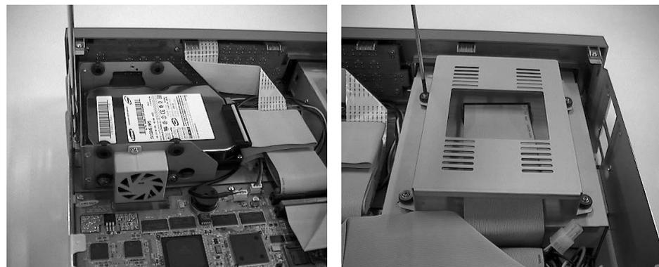
4. Zum Entfernen der Festplattenhalterung (A) lösen Sie das Stromkabel, das Kabel zur Signalübertragung (IDE-Kabel) und das Lüfterkabel. Ziehen Sie die Halterung dann zur Mitte des Geräts, um sie zu lösen. Entfernen Sie die Halterung (B), indem Sie diese nach Entfernen der Schrauben nach oben anheben.
