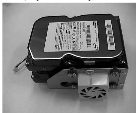
Befestigen Sie die Festplatte auf der Halterung mit den mitgelieferten Spezialschrauben (A)SCREW-SPECIAL (BWH,6-32UNC,L10.5) (4 Stück).
