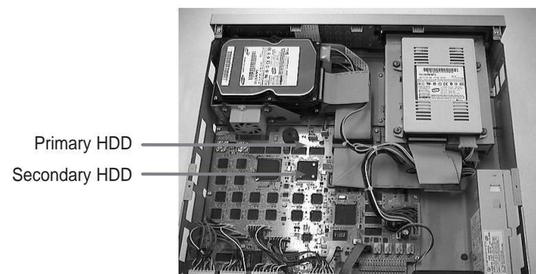
8. Prüfen Sie, ob die Anschlüsse und Verkabelungen ordnungsgemäß befestigt sind, und schließen Sie die Abdeckung.
