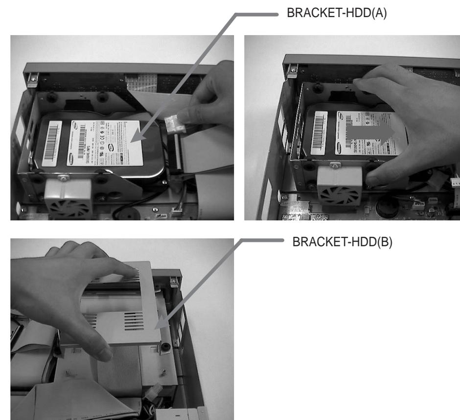
5. Beim Einbau einer zusätzlichen Festplatte muss der Primary Master befestigt werden. Generell sollte eine Festplatte als Primary Master des IDE und das CD-RW-Laufwerk als Secondary Master des IDE installiert werden. Befestigen Sie die Festplatte, die Sie hinzufügen möchten, nachdem Sie die Master/Slave-Jumper in der richtigen Reihenfolge gesetzt haben.
