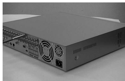
2. Entfernen Sie die Geräteabdeckung. (Schieben Sie die Abdeckung zuerst ein Stück nach hinten, und heben Sie dann den hinteren Teil an.)
