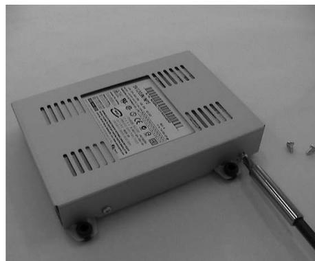
Befestigen Sie die Festplatte auf der Halterung. Verwenden Sie dazu an den 4 Befestigungspunkten die Schrauben "(A)SCREW-SPECIAL (BWH,6-32UNC,L10.5)" und "(B)SCREW-TAPTITE (BH,+,S,M3,L6,ZPC)", die als Zubehör mitgeliefert wurden. (Die Schrauben müssen festgezogen werden, damit es nicht zu Vibrationen kommt.)
